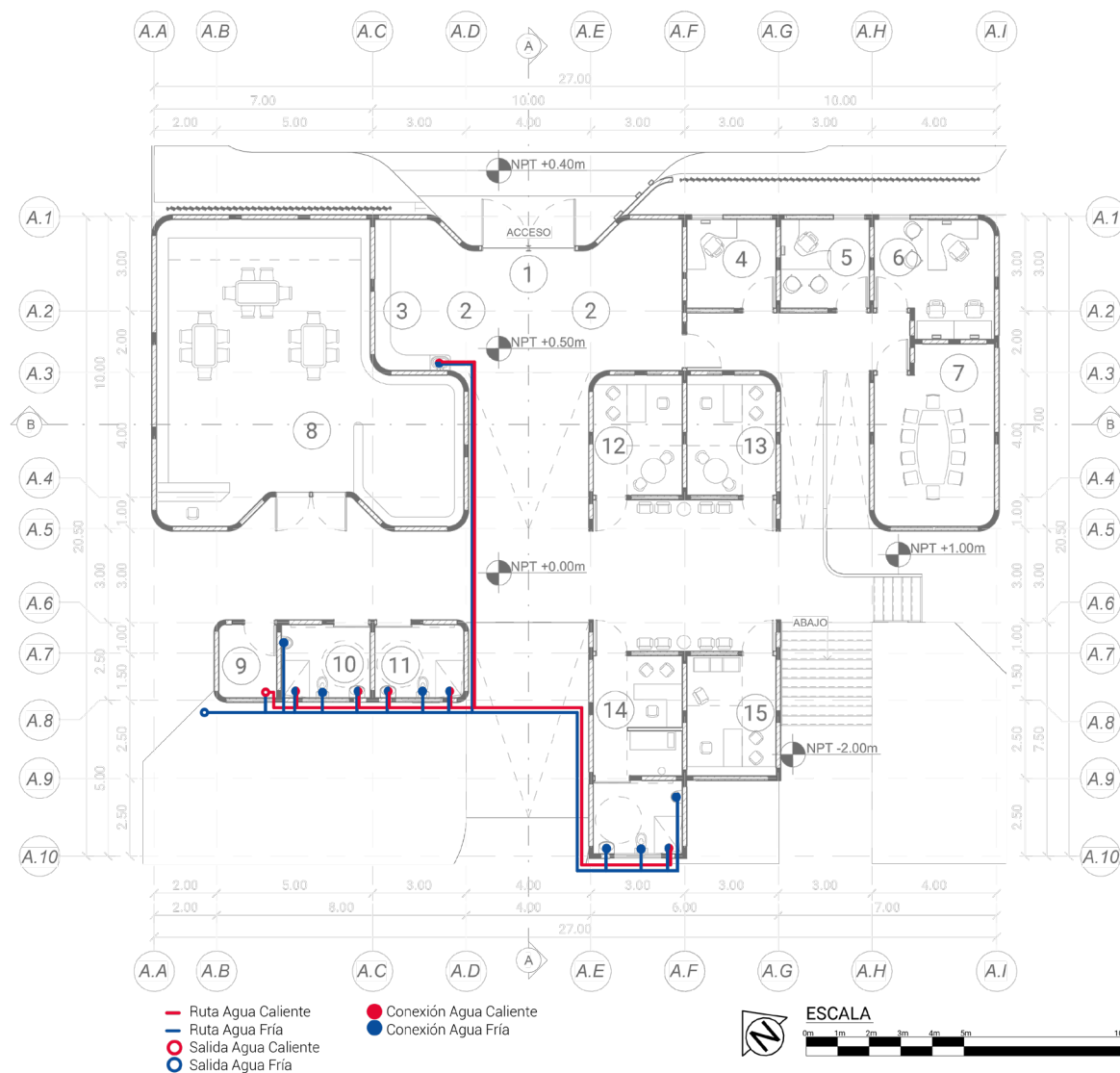
Planta del sistema mecánico del edificio administrativo
