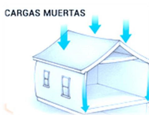
Figura 2.5 Identificación de cargas muertas en una vivienda.
