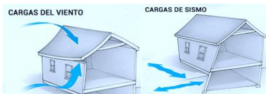
Figura 2.7 Cargas ocasionales en una construcción.
