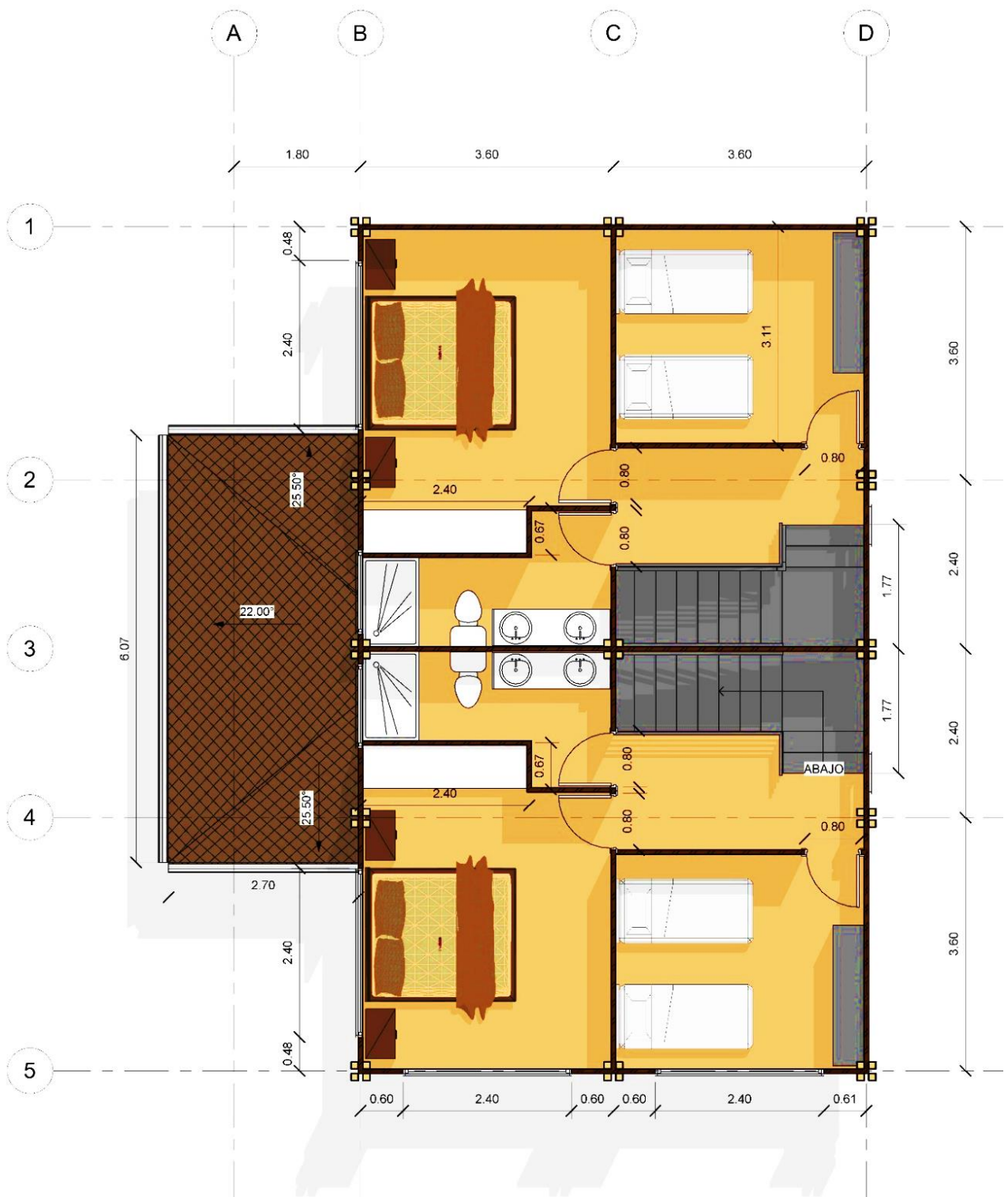
Figura 3.6. Vista en planta, segundo nivel.
