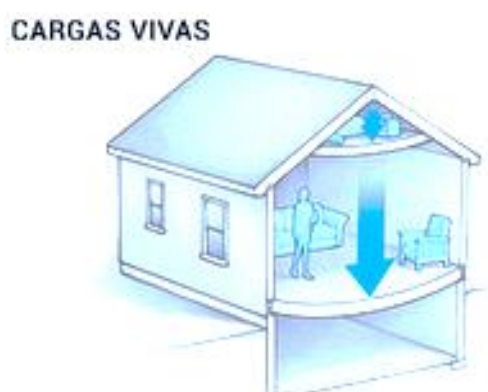
Figura 2.6. Identificación de cargas vivas en una estructura.
