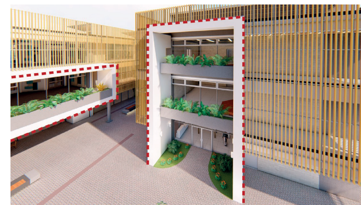
Imagen 175. Aleros y salientes para cubrir radiación y lluvias.
