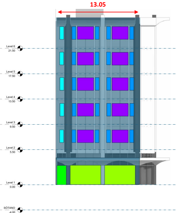
Figura 16. Aberturas para iluminación en la fachada sur, condición existente
