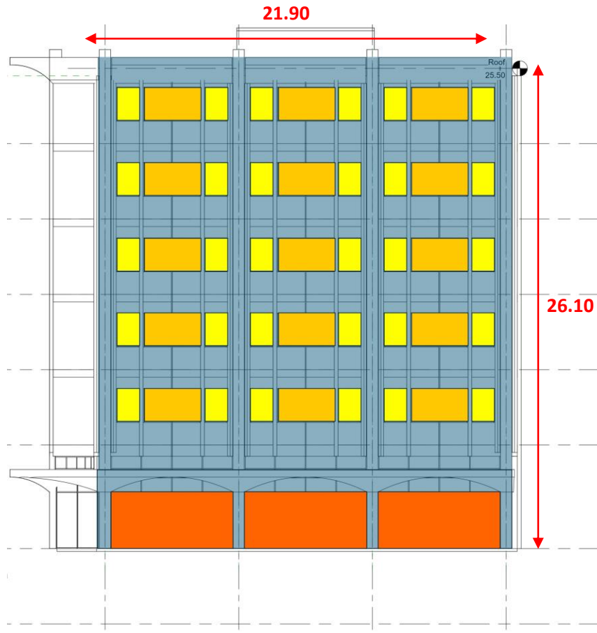
Figura 15. Aberturas para iluminación en la fachada este, condición existente
