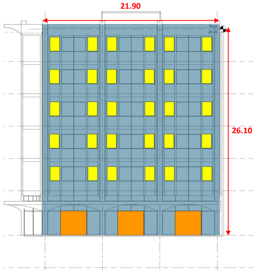
Figura 13. Aberturas para ventilación en la fachada este, condición existente
