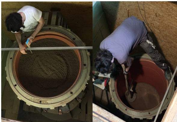
Figura 3.5. Instalación de la muestra en la CC del IBF. Fuente: IBF.
