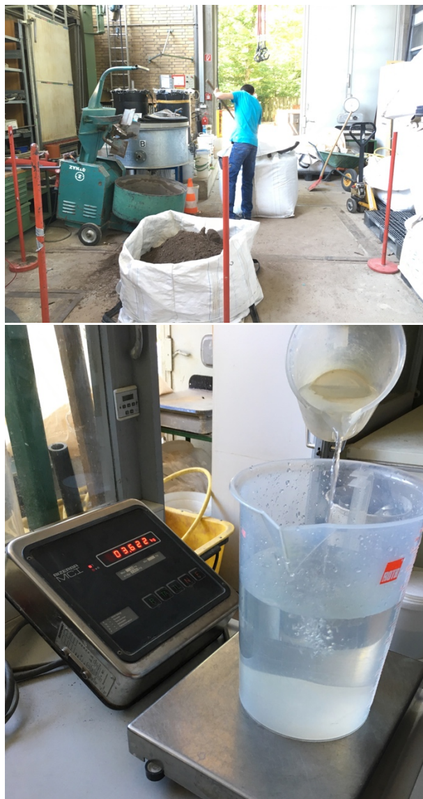
Figura 3.1. Corrección de humedad del material utilizado en los ensayos. Fuente: IBF.
