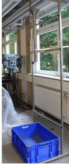
Figura 3.19. Marco de caída con embudo de caída para introducir el material húmedo en el formador de la muestra. Fuente: IBF.
