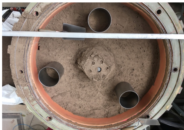
Figura 3.11. Posiciones del muestreo para la profundidad de 12 cm. Fuente: IBF.
