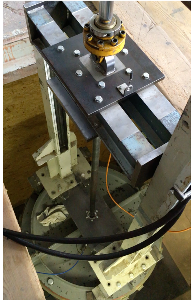
Figura 3.6. Ejecución del CPTu en la CC del IBF. Fuente: IBF.
