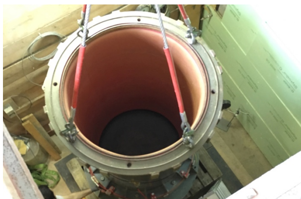
Figura 3.3. Cámara de calibración en el sótano del IBF. Fuente: IBF.
