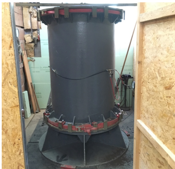
Figura 3.2. Cámara de calibración en el sótano del IBF. Fuente: IBF.
