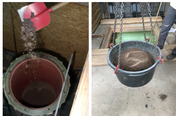
Figura 3.4. Instalación de la muestra en la CC del IBF. Fuente: IBF.
