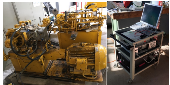
Figura 3.7. Equipo hidráulico y PC utilizados con el ensayo CPTu en el IBF. Fuente: IBF.
