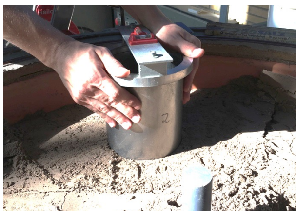
Figura 3.12. Introducción vertical de los cilindros perforadores para el muestreo. Fuente: IBF.
