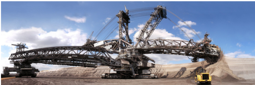
Figura 1.2. Excavadora utilizada en los procesos de extracción de carbón. Fuente: (RWE AG, 2017).
