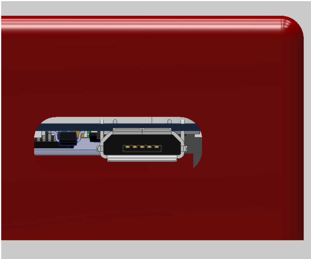
Figura A.5: Asegúrese que el conector micro-USB se encuentra alineado con la abertura del cobertor.
