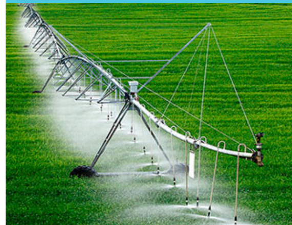
Figura 9. Riego por aspersión auto mecanizado. Fuente www.traxco.es
