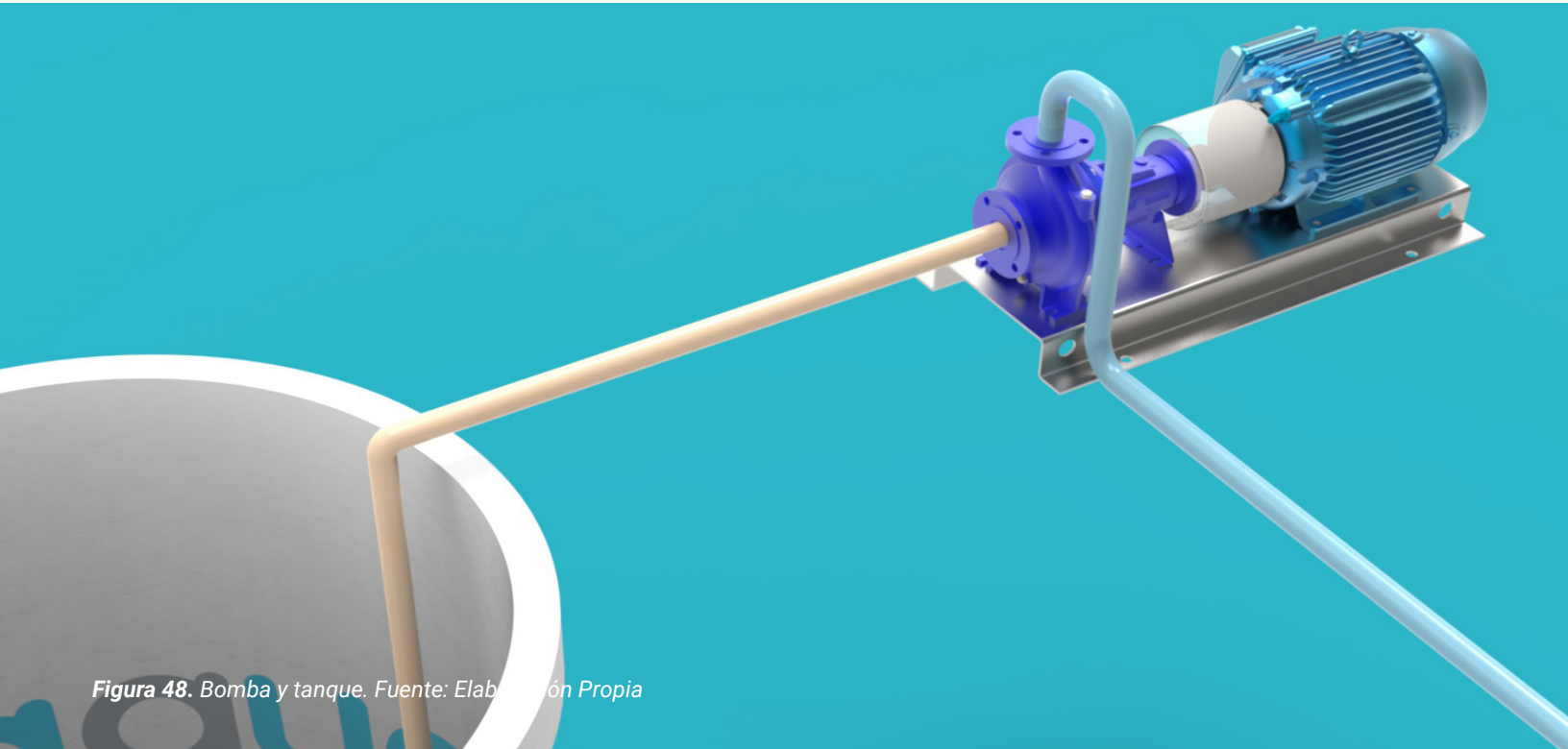
Figura 47. Componentes Sistema Agua. Fuente: Elaboración Propia
