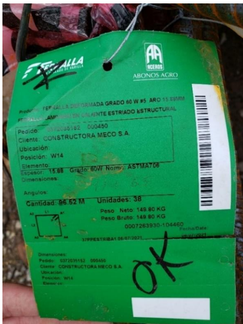
Fotografía 43. Certificados del acero de refuerzo.
