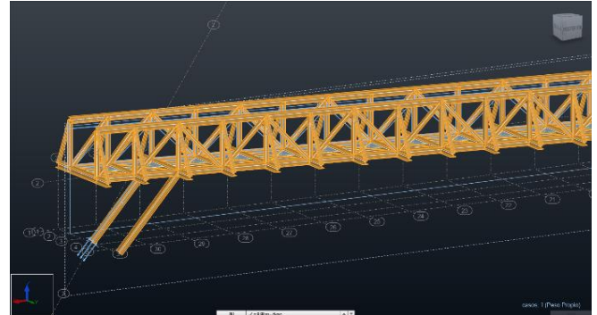
Figura 11. Modelado de la estructura metálica. Elaborado con Autodesk Robot.
