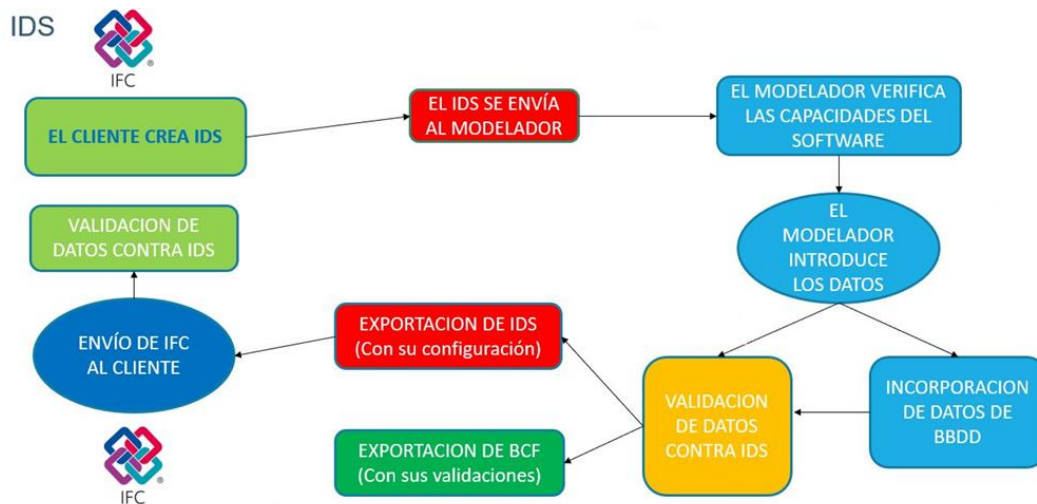
Figura 18. Flujo de trabajo openBIM con IFC e IDS.
