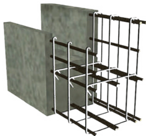
Viga canoa de concreto en colindancias.
