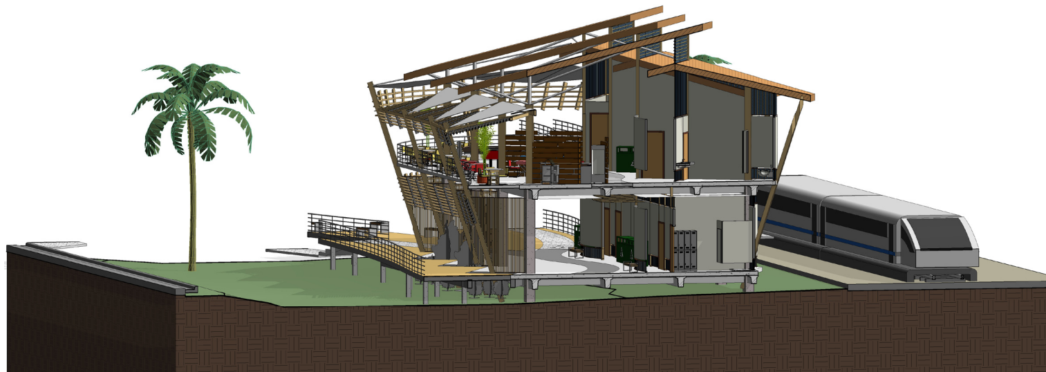
Figura 154. Sección transversal 1. Fuente: El autor, 2012.
