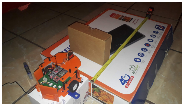
Figura 4.28. Experimento realizado para obtener los valores del sharp en función de la distancia.
