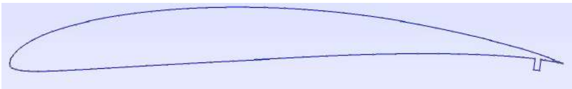
Figura 12. Perfil SG6043 con una aleta de 2% de la longitud de la cuerda ubicada a 95% de la cuerda.
