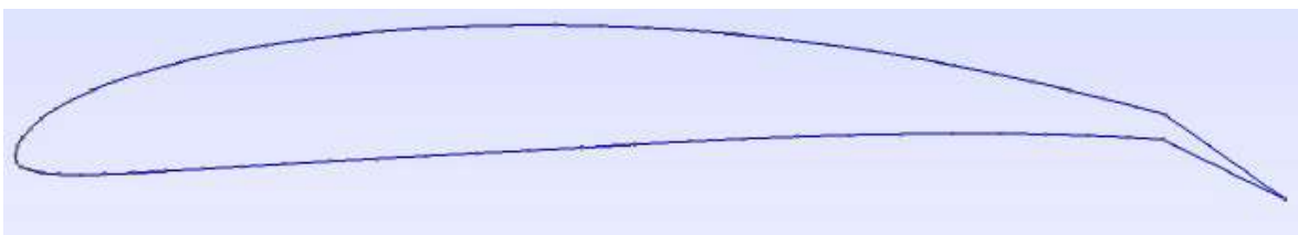
Figura 11. Perfil SG6043 con un alerón de 10% de la longitud de la cuerda y ángulo de -10^\circ .
