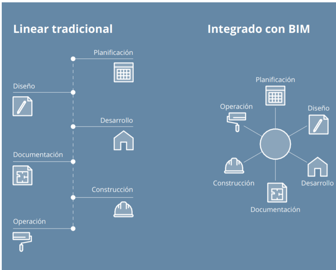
Figura 4. Flujo de Trabajo BIM Y Linear Tradicional.
