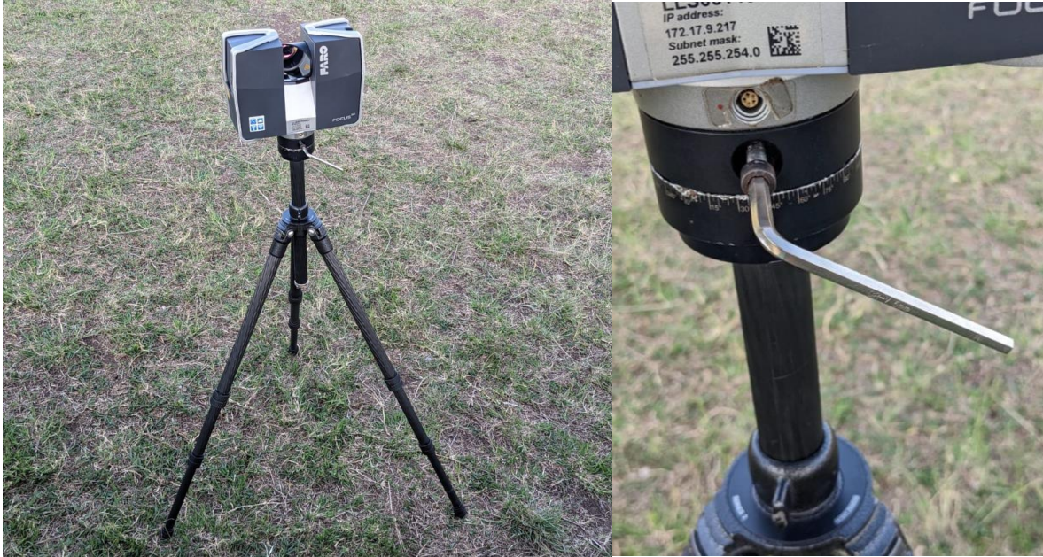
Figura 10. Sensor montado en trípode y acercamiento a la base con tornillo y llave de ajuste.
