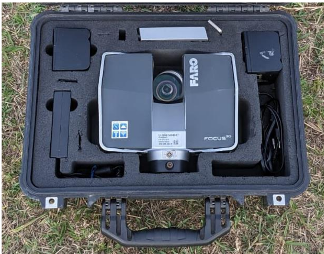
Figura 8. Caja protectora de transporte y contenido, con la unidad de escáner, baterías, cargador y llave Allen.
