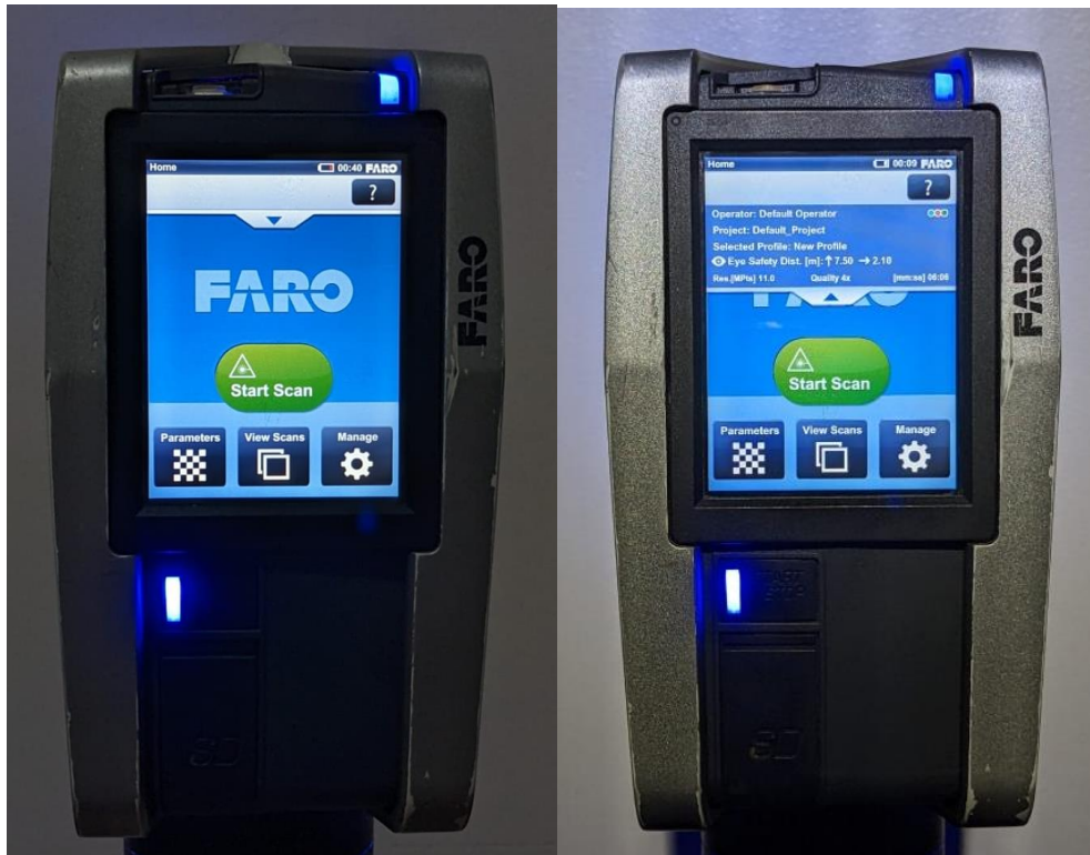
Figura 11. Vista de la pantalla en el menú principal del Escáner Láser Terrestre.
