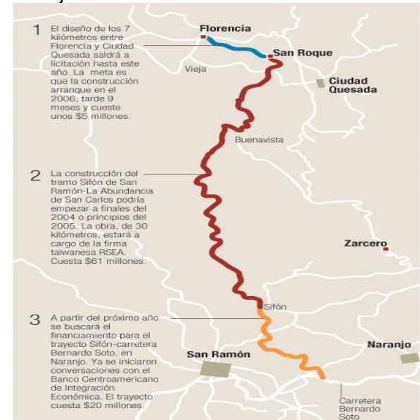
Figura 1. Carretera Nacional: Ruta 35 Fuente: Ministerio de Obras Públicas y transportes (MOPT), 2016.
