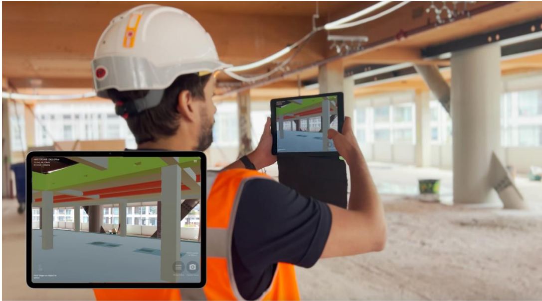
Figura 16. Uso de herramienta RA-BIM para mejorar la comprensión espacial
