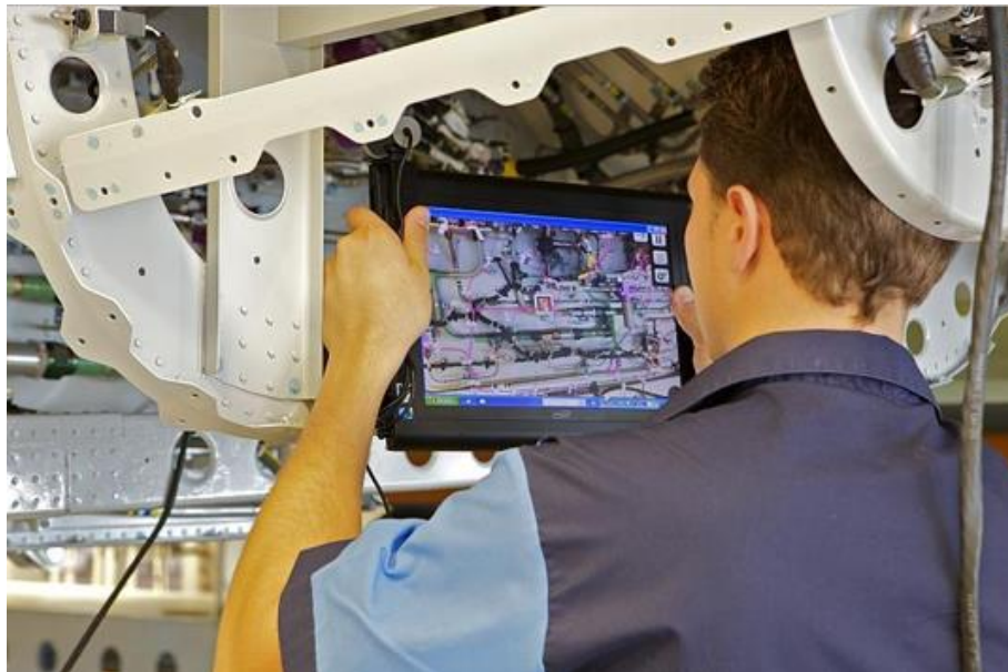
Figura 17. Uso de herramienta RA-BIM control de errores y labores de mantenimiento
