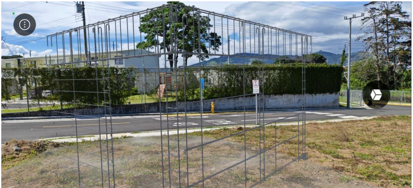
Figura 36. Modelo 3D proyectado mediante la herramienta de RA en campo
