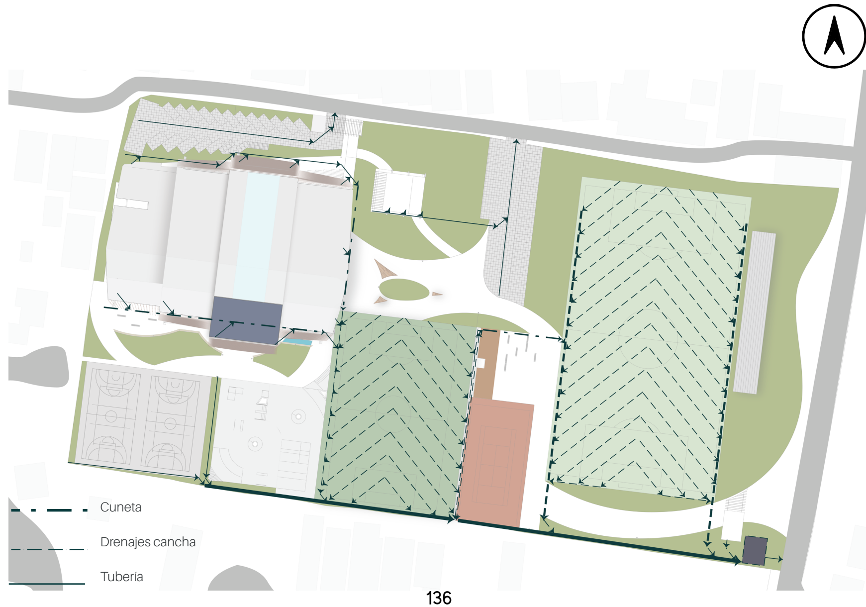
4.6.1 Planta de aguas pluviales
