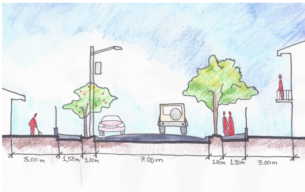
Ilustración 49. Corte típico calles secundarias
