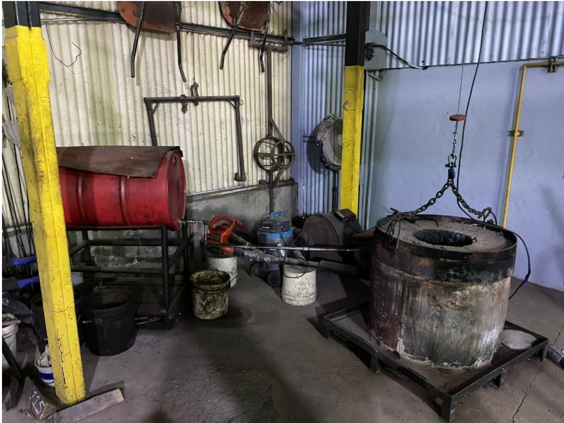
Figura 2. Horno de crisol para fundición de bronce siliconado de la empresa “Casa Fage”
