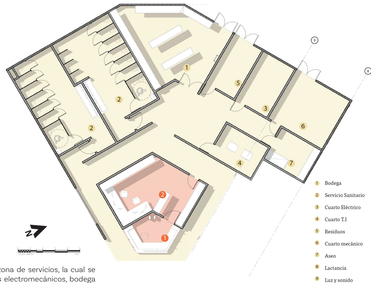
Figura 4.36. Planta sector servicios. Fuente: propia
