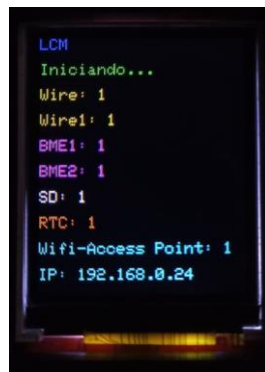
Figura 3.1. Verificación del hardware al encender el dispositivo.
