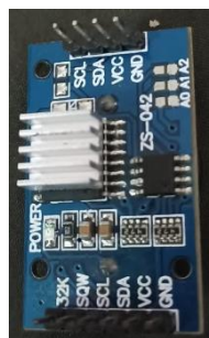
Figura 5.64. Fotografía del disipador del RTC.
