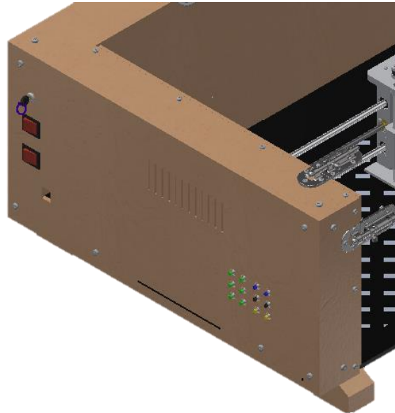
Figura 4-14. Botonera, los interruptores de motores y láser y llave de seguridad. Fuente: Elaboración propia
