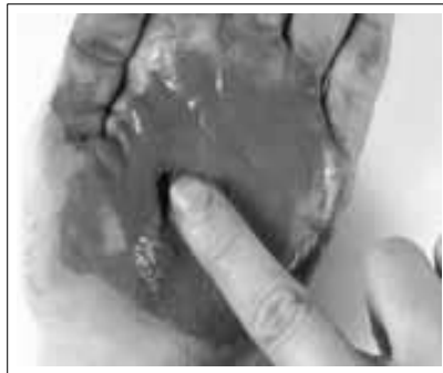
Figura 53: Suelo húmedo y frotado con el dedo índice contra la palma de la mano
