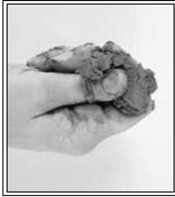
Figura 49: Amasado de la muestra de suelo
