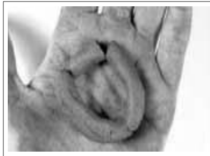
Figura 51: Rompimiento del cilindro alargado al formar un círculo
