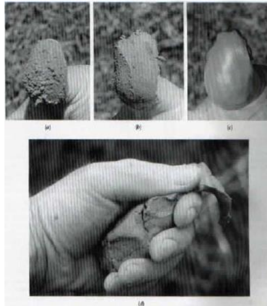
Figura 45: Suelo entre los dedos para textura al tacto
