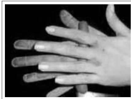
Figura 50: Confección de un cilindro alargado de la muestra de suelo
