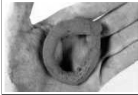
Figura 52: No rompimiento del cilindro alargado al formar un círculo
