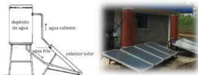
Figura. 7. Calentador solar de agua con colectores planos, depósito de agua caliente con aislamiento térmico y circulación por termosifón. Lechería ITCR-SSC.
