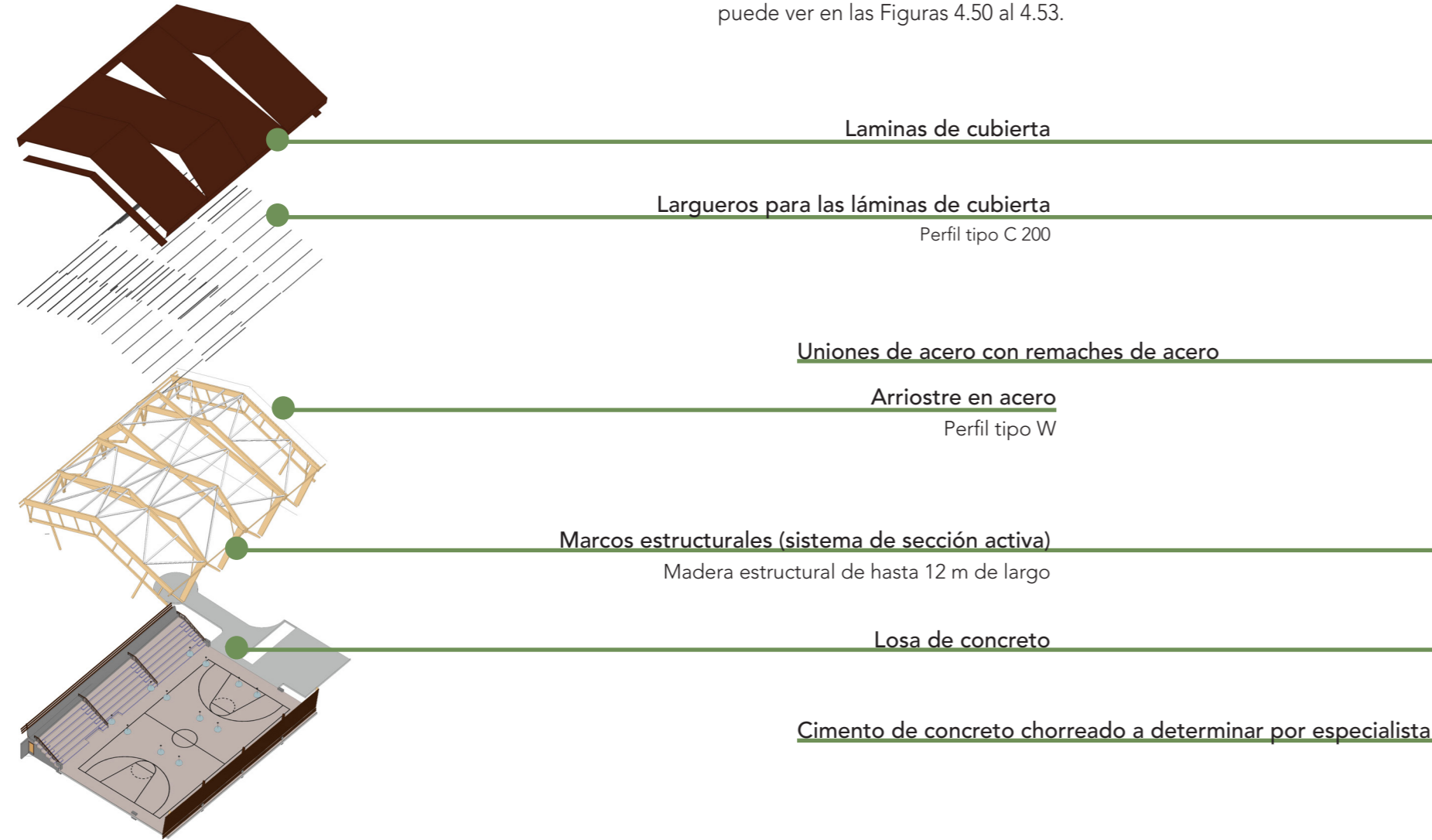
Figura 4.50. Isométrico. Detalle de elementos estructurales en cancha
