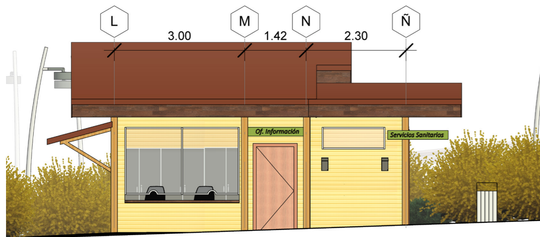
Figura 4.38. Fachada este Oficina de información
