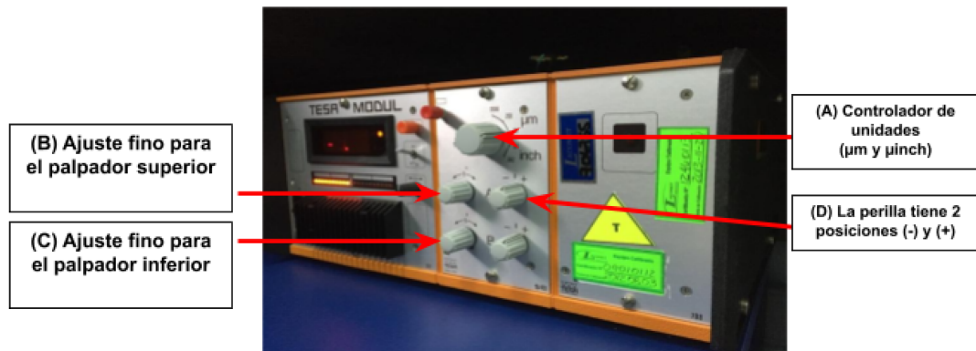
Figura 4.12: Identificación de las funciones de los diales del equipo TESA MODUL. Fuente: [8, p. 11]
