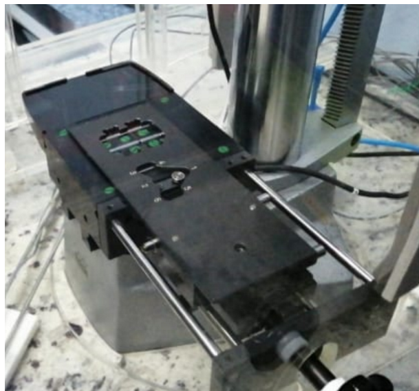
Figura 4.4: Fotografía explicativa del paso número 3 del proceso de calibración dimensional. Fuente: Elaboración propia
