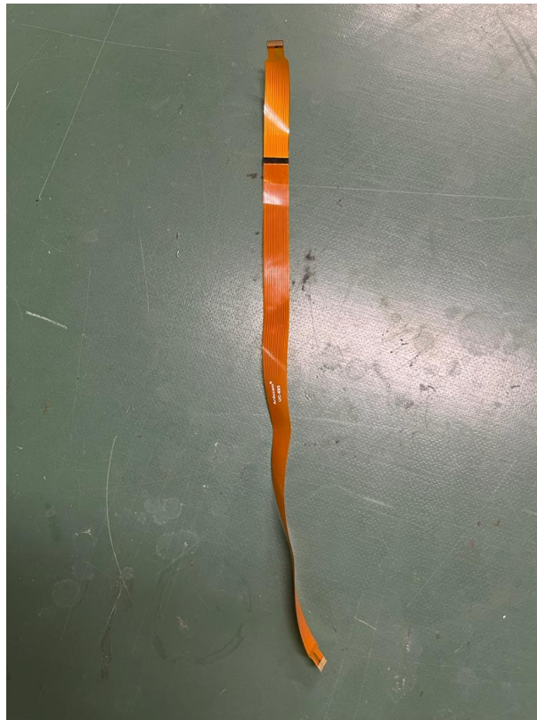
Figura 5.1: Cable formado con dos cables para obtener los conectores correctos. Fuente propia
