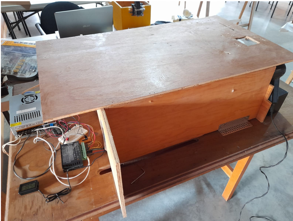
Figura 4.11: Primer modelo de la cámara de aislamiento térmico
