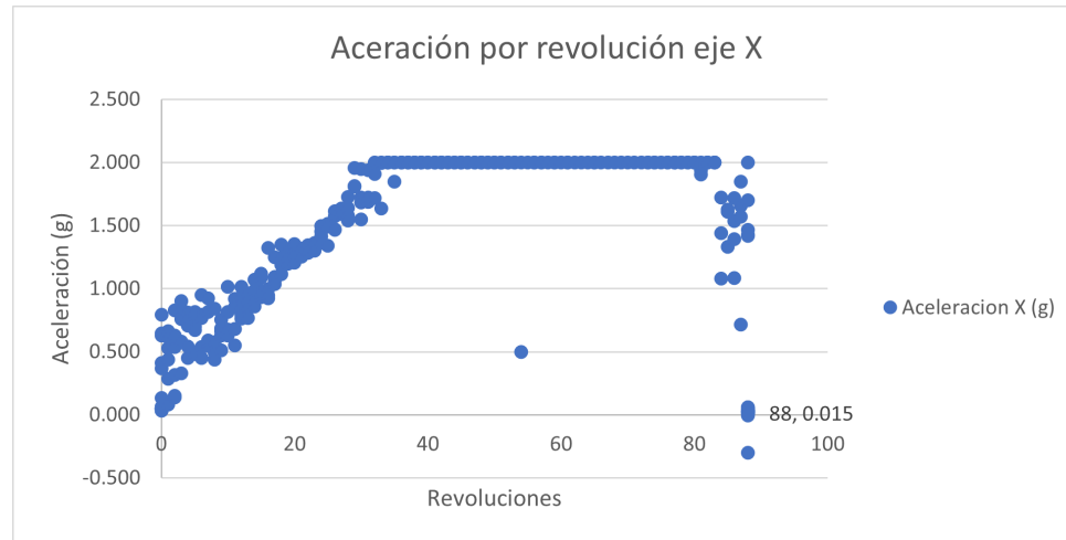
Figura 5.24: Primeros datos obtenidos para el eje X en el sistema de centrifugación.
