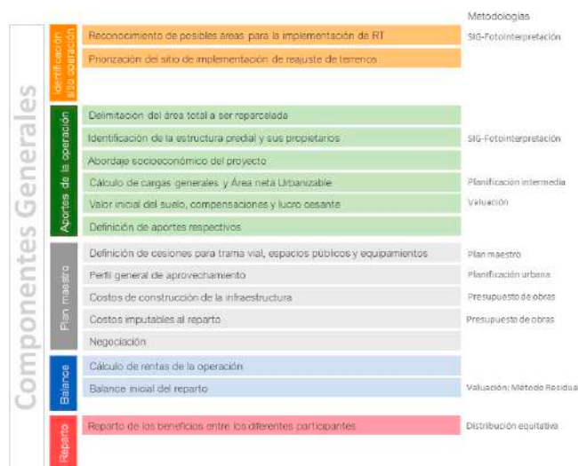
Imagen 15. Esquema general con los pasos de la metodología. Fuente: Instituto de Fomento y Asesoría Municipal, Instituto Nacional de Vivienda y Urbanismo Ministerio de Vivienda y Asentamientos Humanos. (2019).
