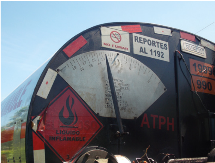
Figura 22. Medidor volumétrico del tanque distribuidor Fuente: LanammeUCR, 2018
