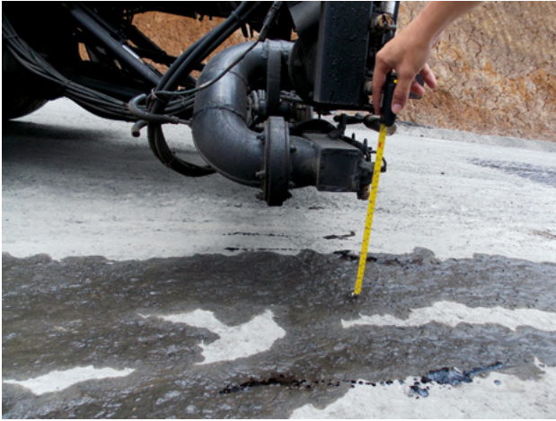
Figura 13. Medición de la altura de la barra rociadora con cinta métrica Fuente: LanammeUCR, 2018
