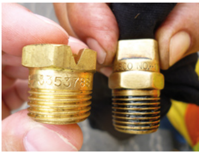
Figura 16. Variación en tamaño de boquilla de acuerdo al fabricante Fuente: LanammeUCR, 2018
