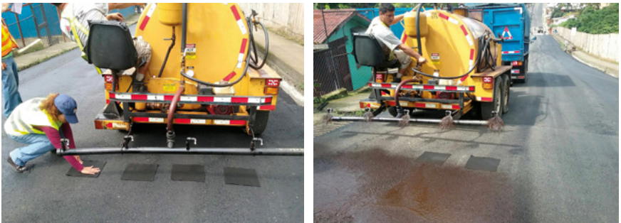
Figura 17. Ensayos para verificar uniformidad de riego y determinar la cantidad de emulsión aplicada Fuente: LanammeUCR, 2018
