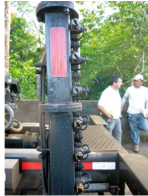
Figura 43. Riego de liga no uniforme y sin adecuada cobertura, producto del uso de boquillas con una abertura mayor según tasa de dosificación aplicada Fuente: LanammeUCR, 2016
