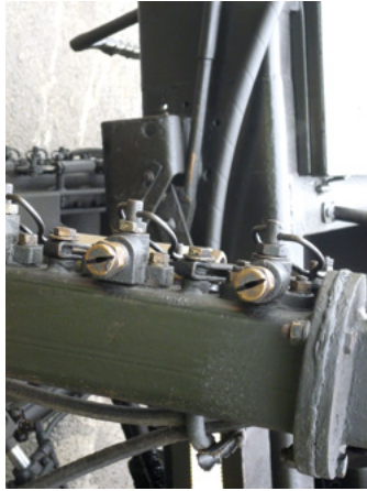
Figura 30. Orientación de boquillas colocadas en la misma dirección
