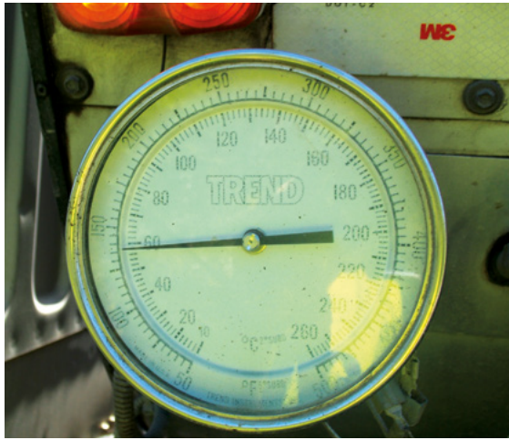
Figura 11. Termómetro para verificar temperatura de almacenamiento y aplicación de la emulsión Fuente: LanammeUCR, 2018
