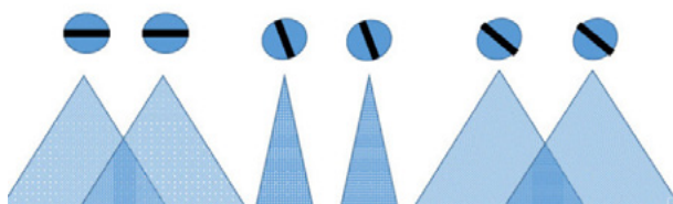
Figura 15. Efecto orientación de boquillas en riego de liga. Fuente: Asphalt Institute, 2014.
