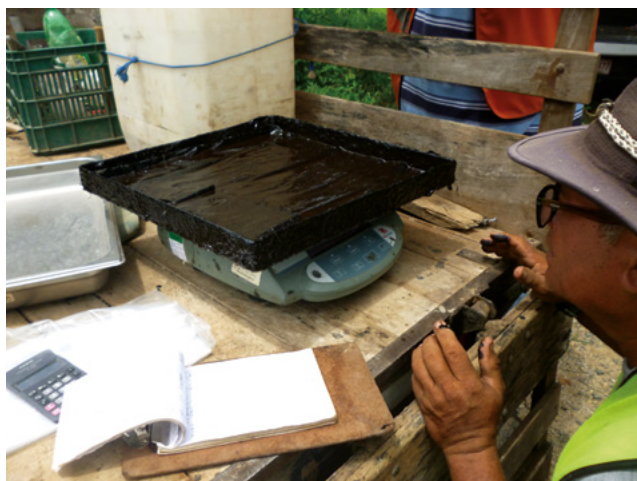
Figura 26. Ensayos para verificar que el riego sea uniforme y determinar la cantidad de emulsión aplicada
