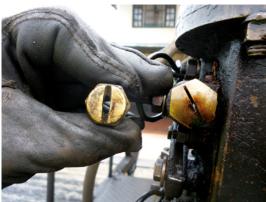
Figura 29. Selección de boquillas de acuerdo con las características del camión dosificador y la tasa de dosificación deseada
