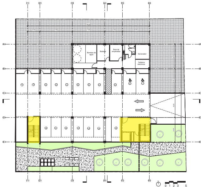
Figura 4.55: Planta estacionamiento. Fuente propia.
