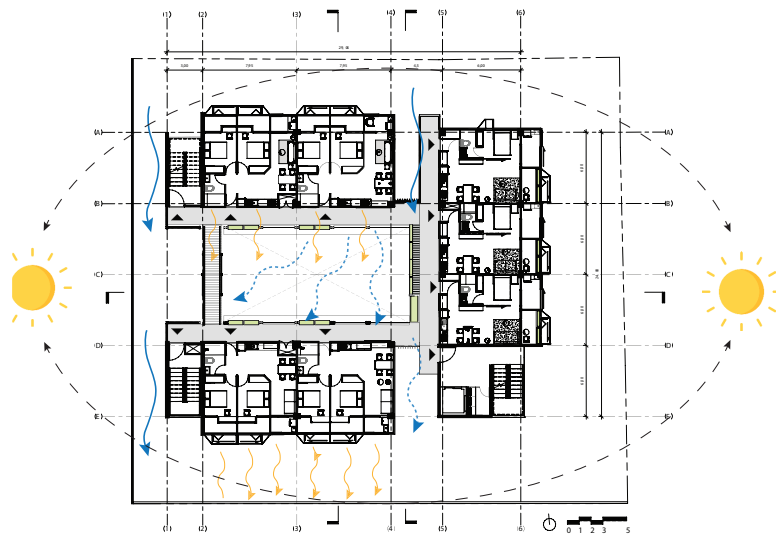
Figura 4.52: Diagrama flujo de vientos y radiación en planta. Fuente propia.
