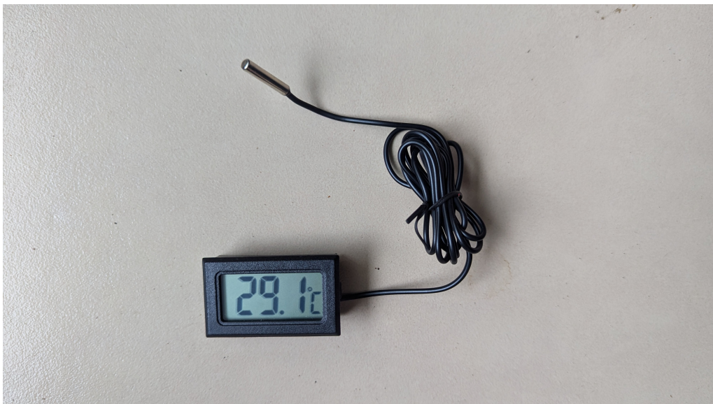
Figura 5.16: Termómetro digital utilizado como patrón para las pruebas de incertidumbre de medidas de temperatura.
