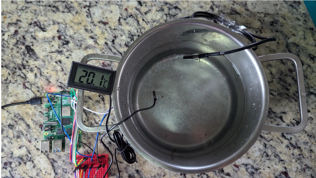
Figura 5.17: Ejemplo de la configuración para las pruebas de medición de temperatura a 20 °C.
