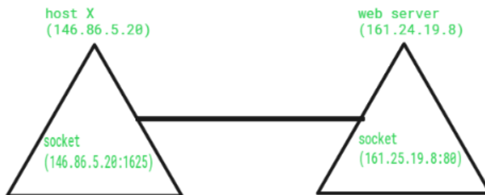
Figura 2.16: Representación gráfica del uso de sockets, cada triángulo representa un dispositivo diferente. [31]
