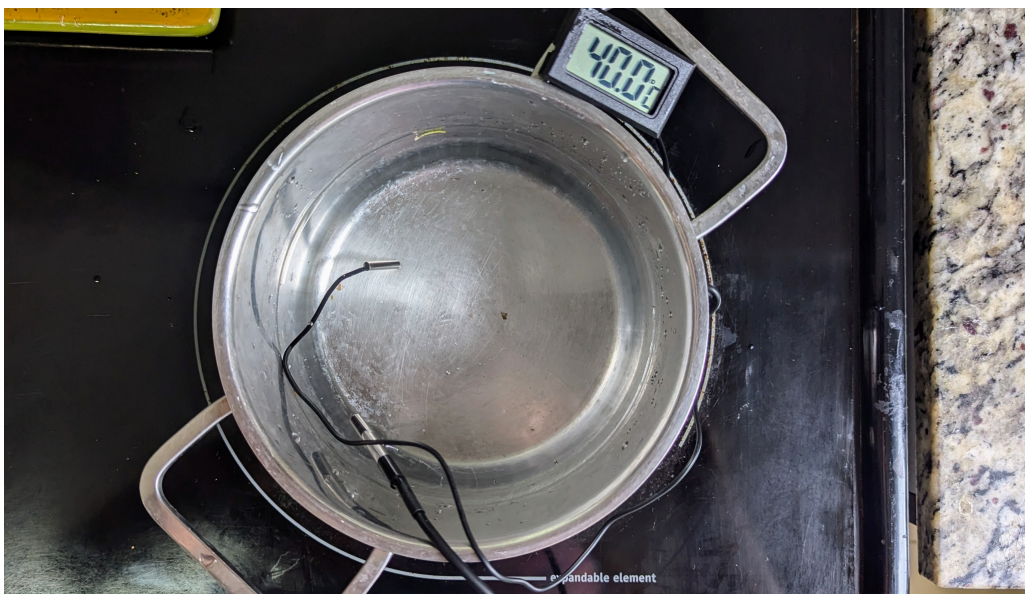
Figura 5.18: Ejemplo de la configuración para las pruebas de medición de temperatura a 40 °C.
