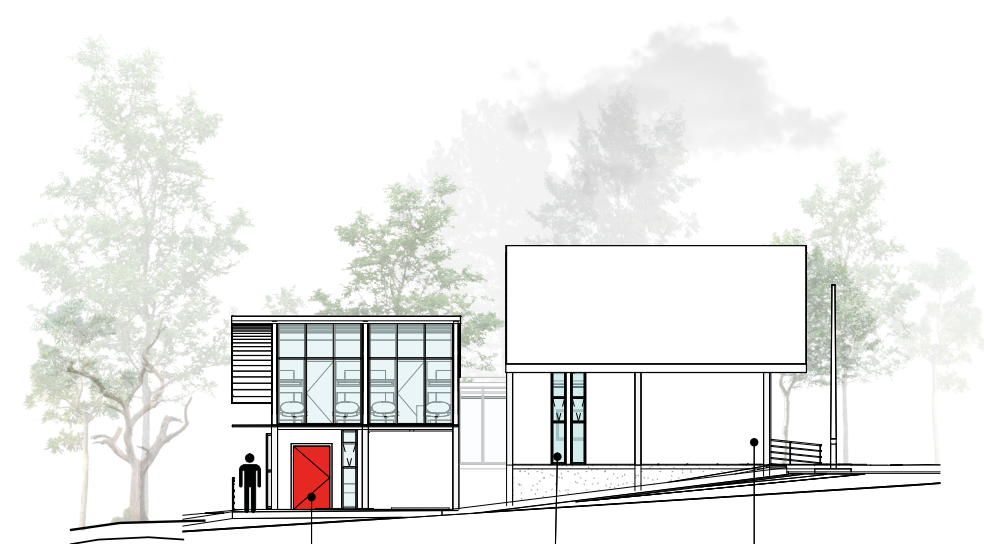
Puerta metálica con acabado rojo metálico. Cerramiento de vidrio transparente con marcos de aluminio en negro mate. Cerramiento en densglass con acabado de pintura mate blanca.
