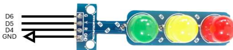
Fig. 50. Diagrama de conexión módulo de LEDs
