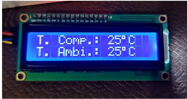
Fig. 37. Resultados de las temperaturas mostradas en la pantalla LCD
