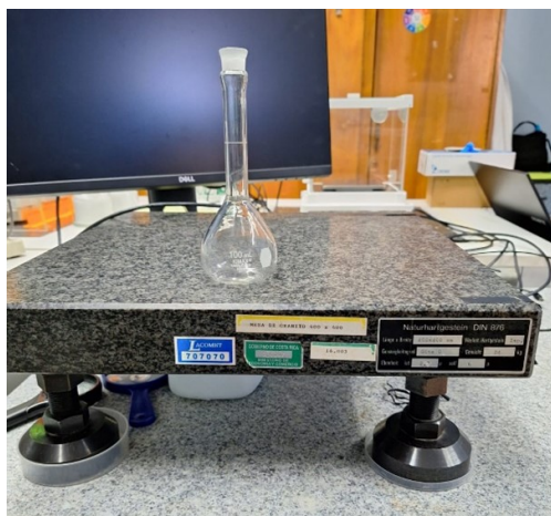
Figura 4.9. Cristalería a calibrar sobre la mesa de plenitud.
