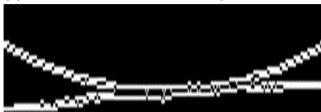
(b) Menisco cercano a la línea de aforo.
