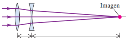
Figura 2.6. Diagrama de cómo los rayos de luz inciden en la lente y se unen a una distancia focal. [32]
