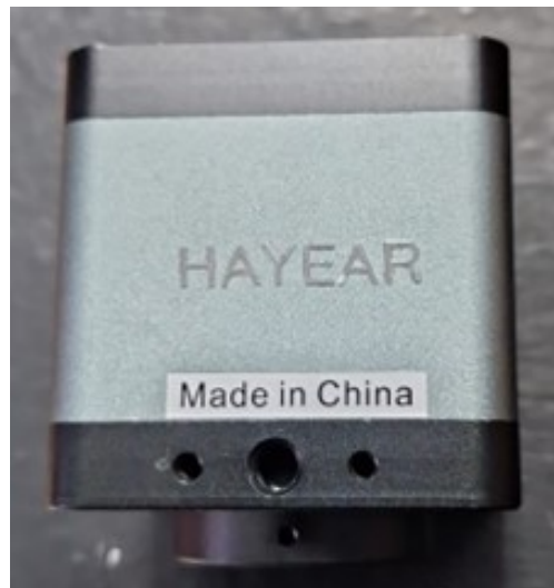
Figura B.8. Vista de la cámara para apreciar los agujeros de sujeción de tornillos.
