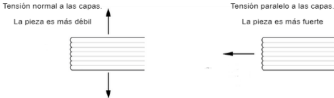
Figura 5.20. Impacto de las cargas en tensión según la orientación de la pieza. [44]
