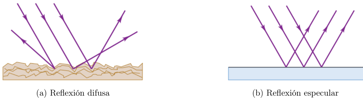
Figura 2.8. Tipos de reflexión dependiendo del material de incidencia. [32]
