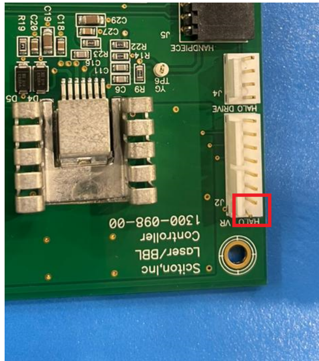
Figura 3.5: PCB 98 L con pines torcidos.
