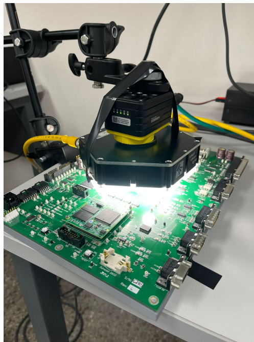
Figura 5.11: Colocación de la PCB en el sistema de validación. Elaboración propia.
