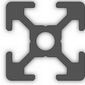
Figura 4.1: Perfil estructural utilizado. Elaboración propia.
