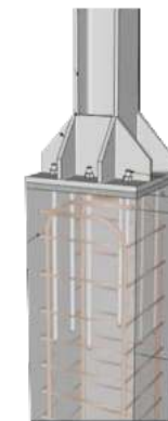
DIAGRAMA CONEXIÓN COLUMNA DE CONCRETO - ACERO
