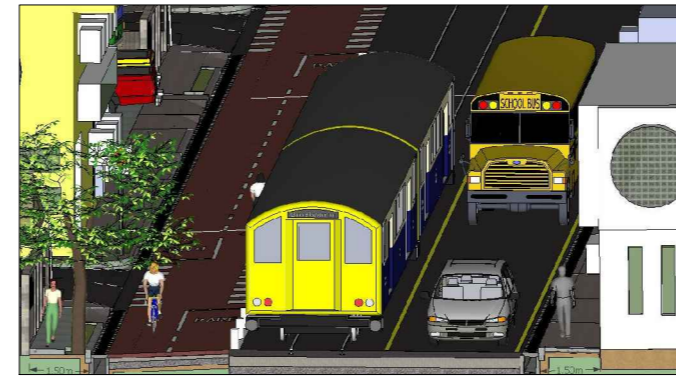
VISTAS SECCIÓN TRANSVERSAL TÍPICA DE FAJA CICLISTA, 3,0 m DE ANCHO
