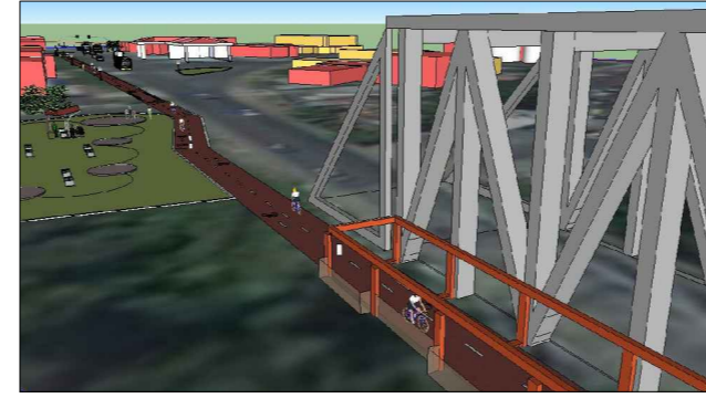
Paso de la faja ciclista sobre el puente Bailey
