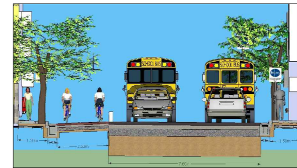
SECCIÓN TRANSVERSAL TÍPICA DE FAJA CICLISTA, 3.0 m DE ANCHO
