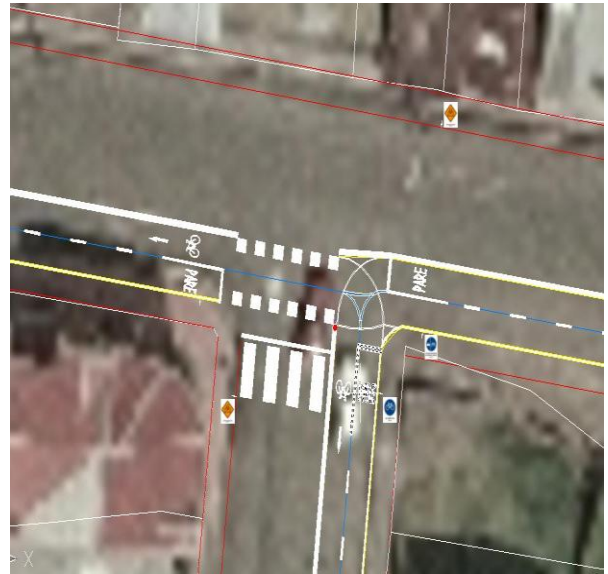
Figura 56. Unión de circuitos en Avenida 6.
