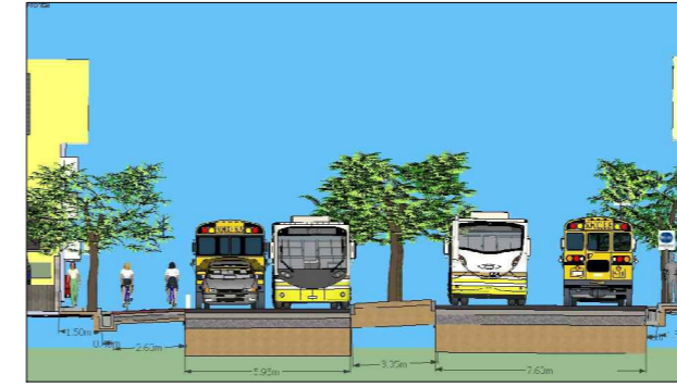
SECCIÓN TRANSVERSAL TÍPICA DE FAJA CICLISTA, 3.0 m DE ANCHO
