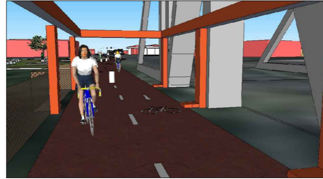
Estructura en voladizo sobre puente Bailey
