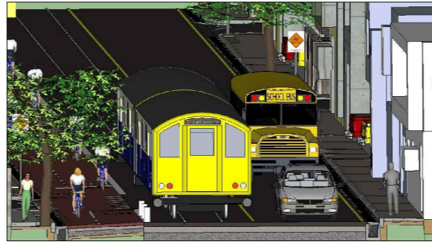
VISTAS SECCIÓN TRANSVERSAL TÍPICA DE FAJA CICLISTA, 2,6 m DE ANCHO
