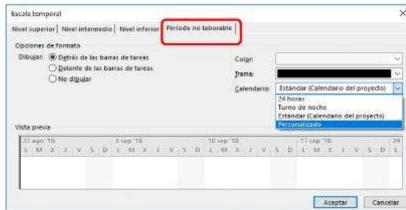
Figura N° 10 Ajustar Calendario en Escala Temporal (Ficha Vista \ Opción Escala Temporal \ Pestaña "Período no laborable" \ Opción "Calendario")
