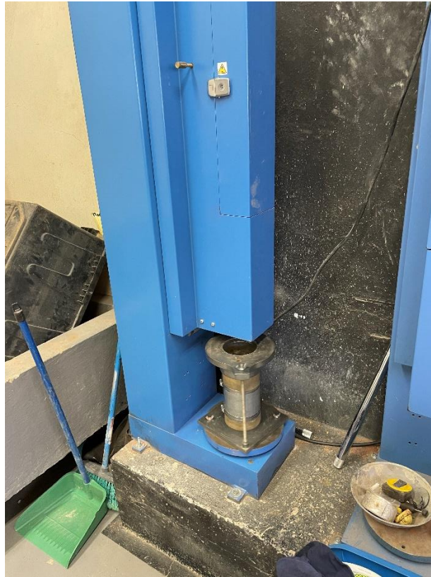
Figura 4.37. Compactación de los especímenes por medio de compactador mecánico, mazo estándar 5,5 lb, 6 capas.
