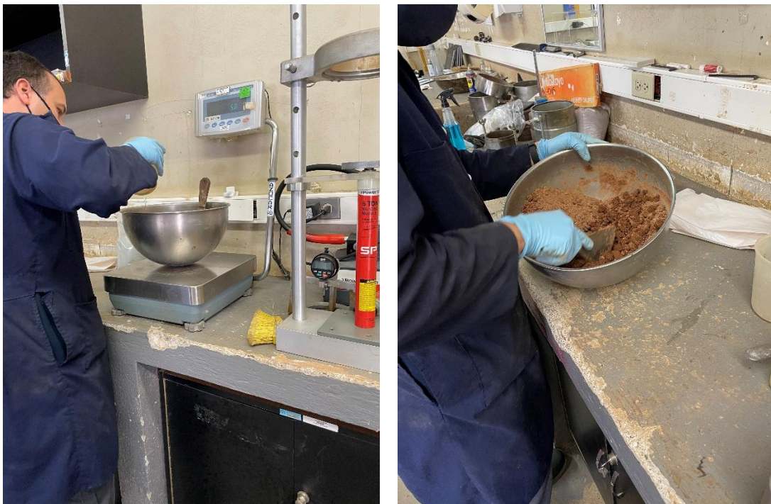
Figura 4.36. Adición de agua y aditivo para la posterior homogenización de la mezcla.
