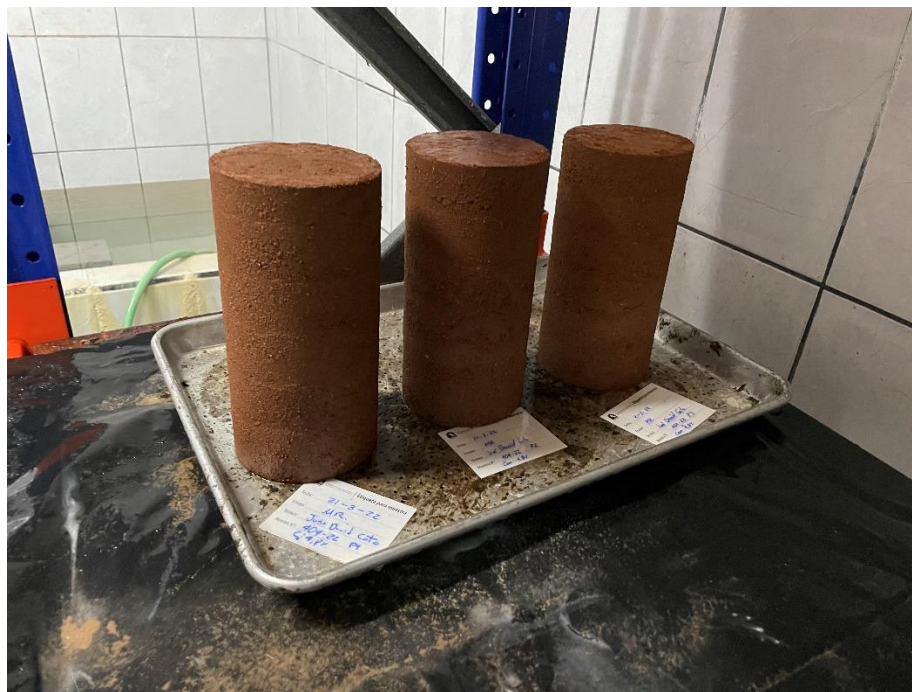
Figura 4.40. Curado de especímenes de suelo combinado con cemento hidráulico en cuarto húmedo.
