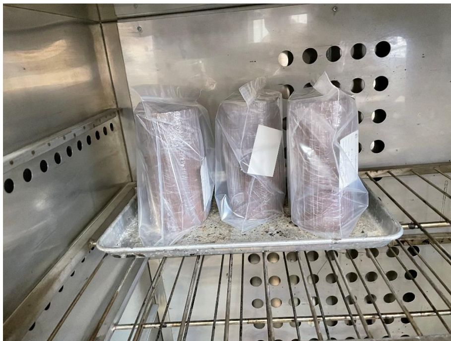
Figura 4.41. Curado de especímenes de suelo combinado con cal en horno a 40°C.
