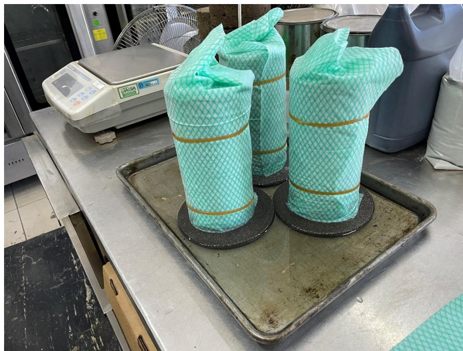
Figura 4.42. Remojo capilar de especímenes de suelo combinado con cal por 24 horas.
