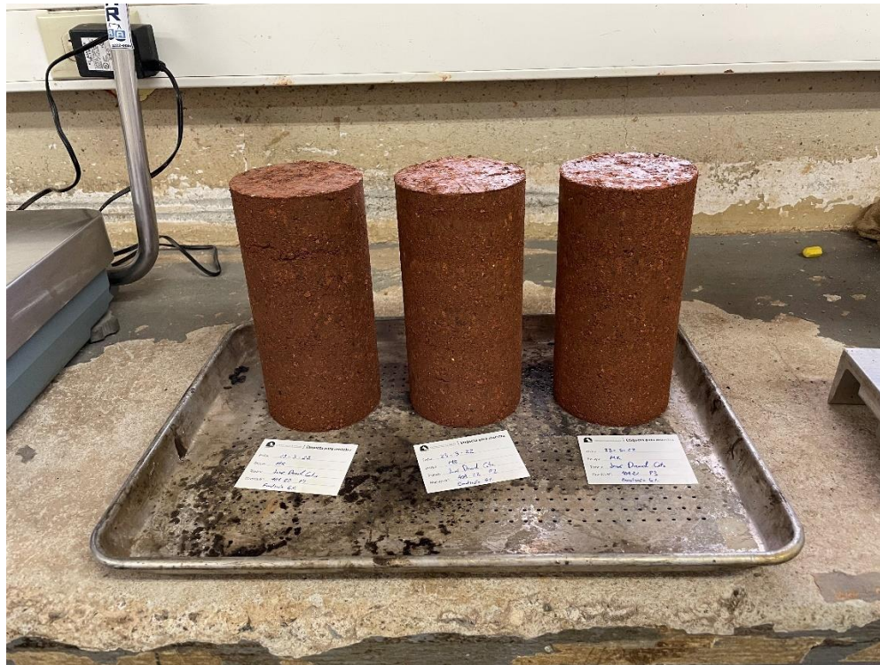
Figura 4.39. Especímenes moldeados para ensayo de módulo resiliente.
