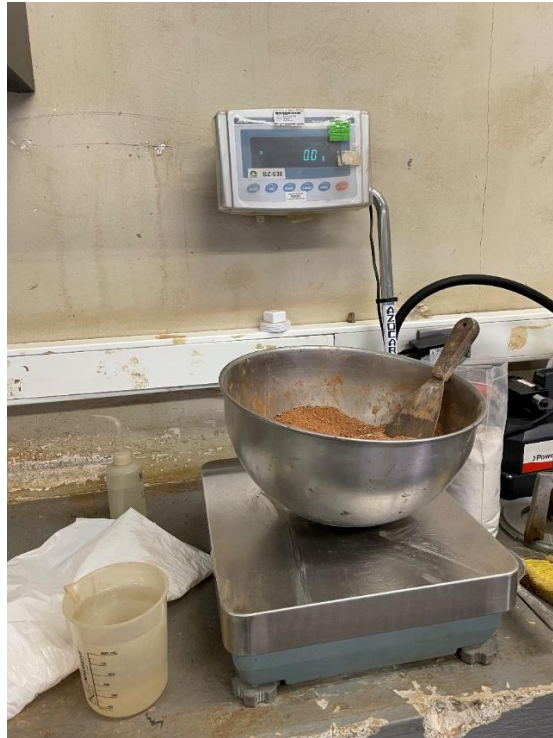
Figura 4.35. Proceso de mezclado de suelo, aditivo y agua.
