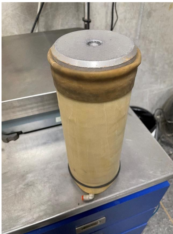
Figura 4.45. Espécimen listo para colocarlo dentro de la cámara triaxial.
