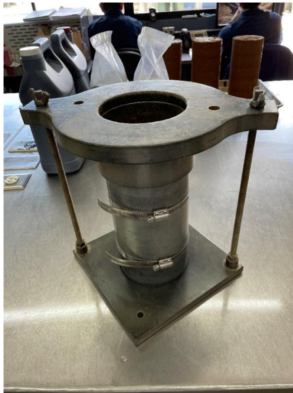
Figura 4.38. Molde de compactación de 4 in de diámetro (sin membrana).
