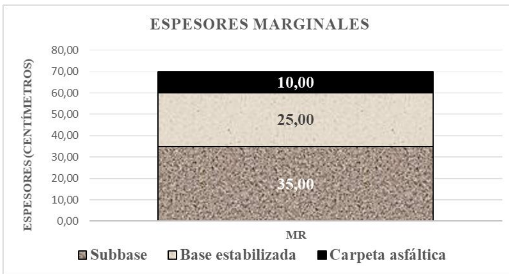
Figura 4.18. Estructura verificada para marginales, espesores en cm.
