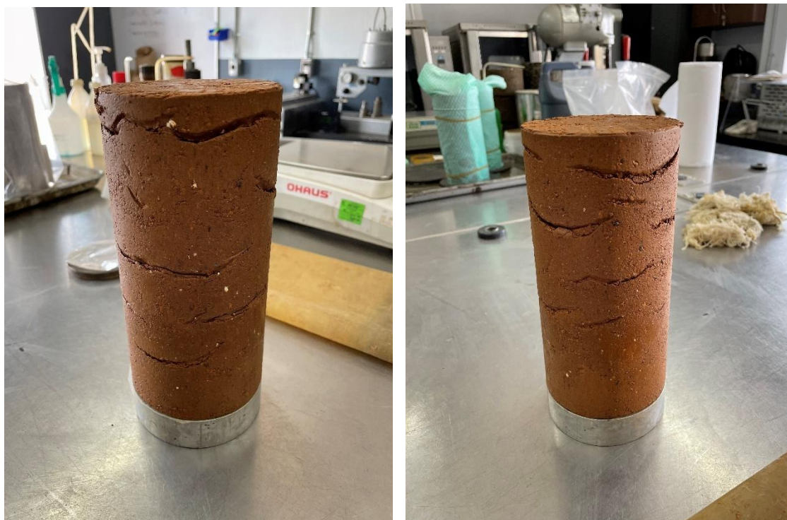
Figura 4.55. Especímenes compactados para ensayo MR de suelo combinado con cal.
