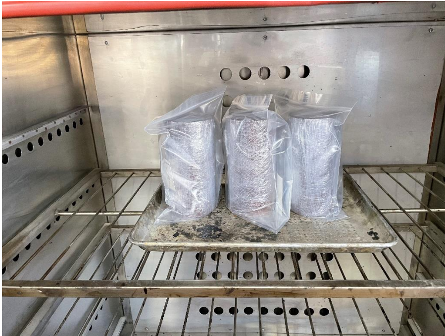
Figura 4.43. Curado de especímenes de suelo combinado con emulsión asfáltica en horno a 40°C.
