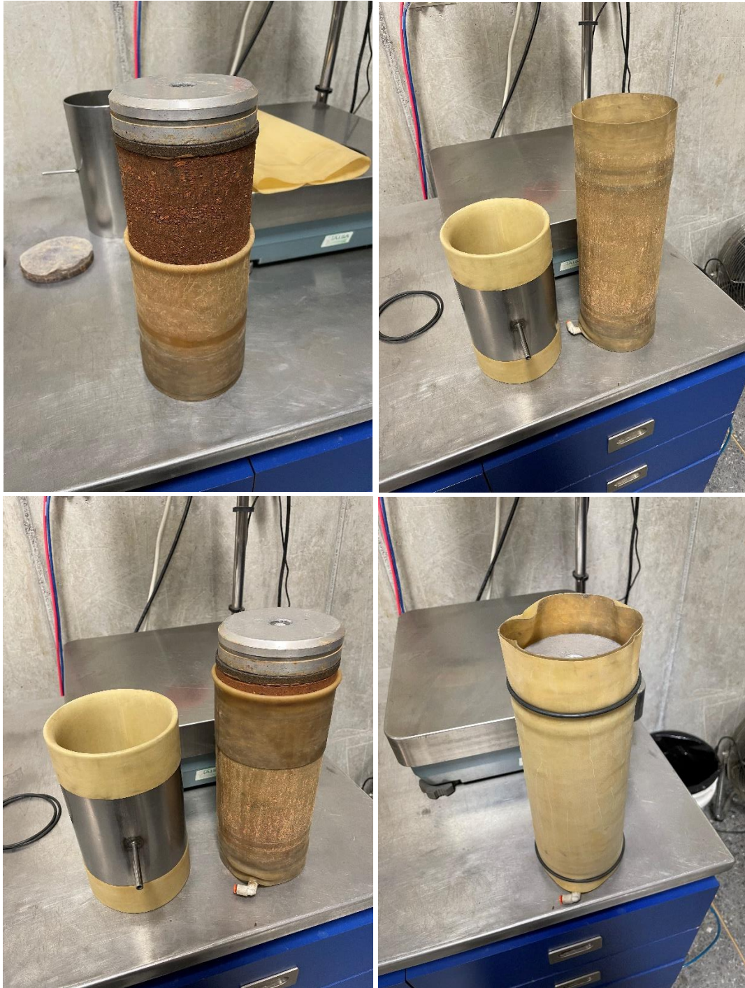
Figura 4.44. Preparación del espécimen previo al ensayo de módulo resiliente.
