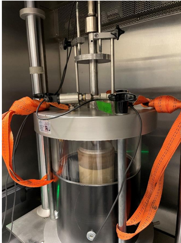
Figura 4.46. Cámara triaxial instalada en la máquina de carga.
