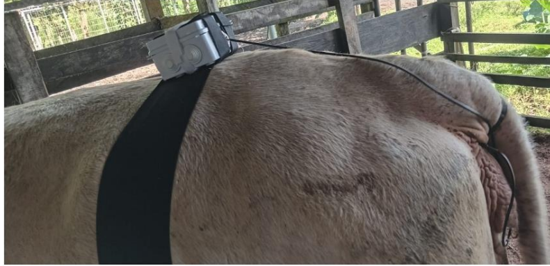
Figura 11. Posicionamiento del sistema embebido para monitoreo de Temperatura Corporal central (rectal)
