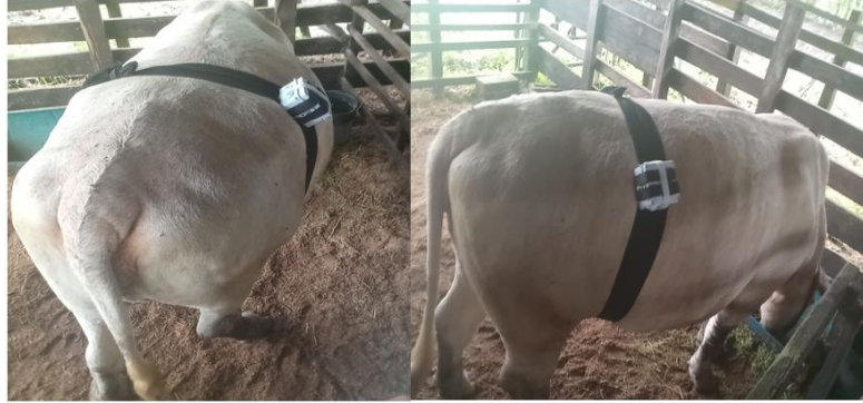
Figura 12. Ubicación del sensor MPU-6050 sobre la zona paralumbar en bovinos
