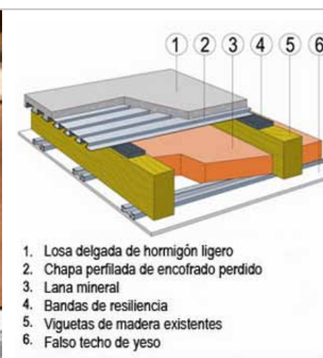
Imagen 3.3.38. Aislamiento acústico para sistemas de entrepiso.
