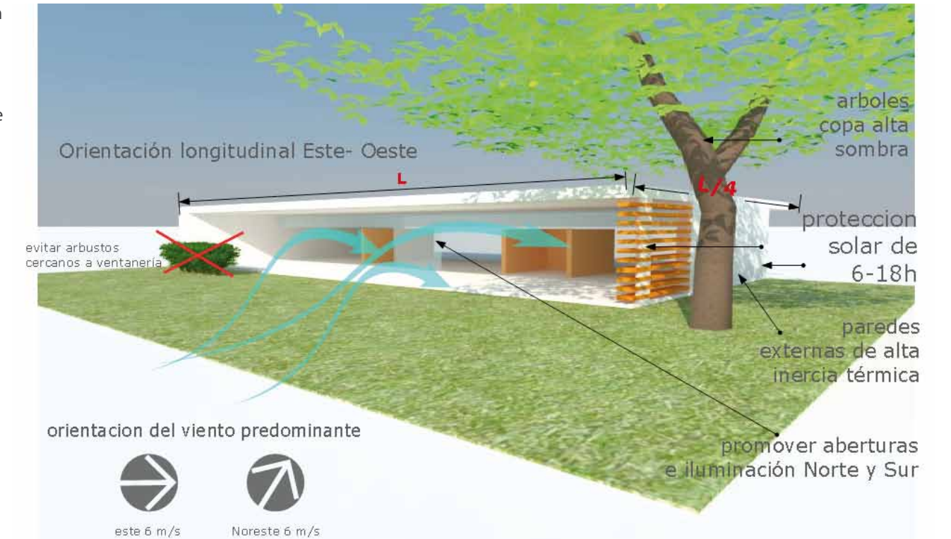
Imagen 5.4.11. Resumen de principales estrategias pasivas a implementar en el diseño.
