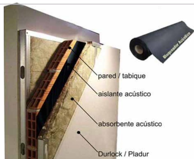
Imagen 3.3.34 Aislamiento acústico mixto Mampostería-muro seco. STC= 61.
