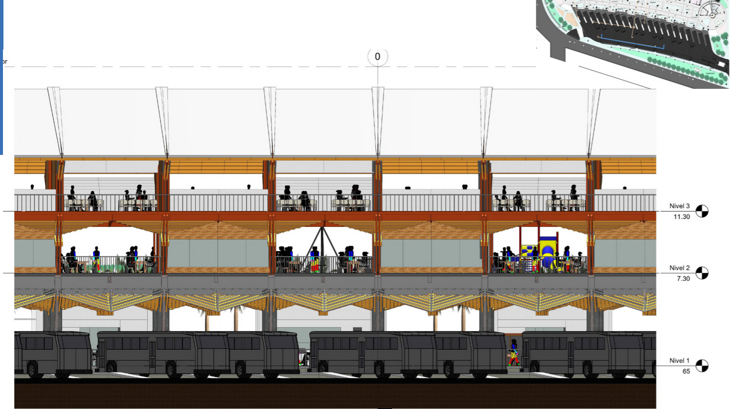
Plano 11: Sección 2 del módulo de comercial / Andén
