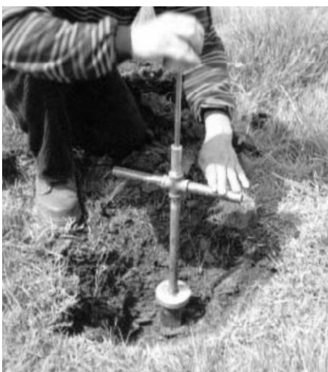
Figura 20: Equipo completo de muestreo de suelos para muestras indisturbadas Tomado de: (Chavarría, 2009)
