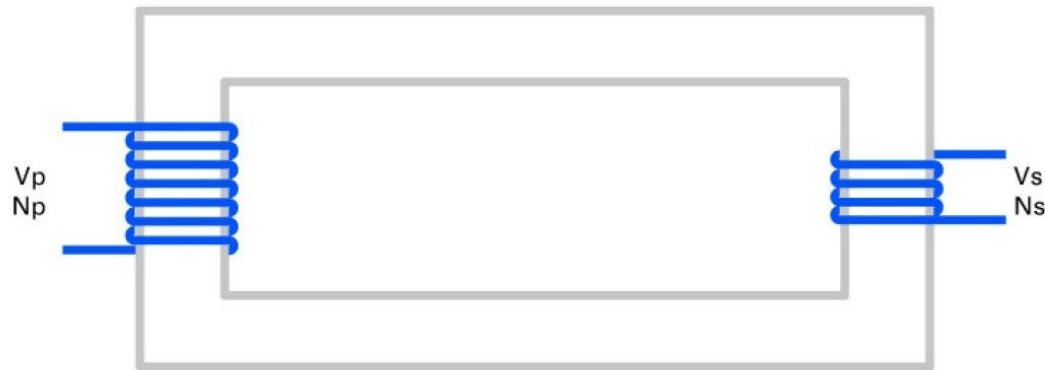
Figura 2.3: Transformador de potencia reductor
