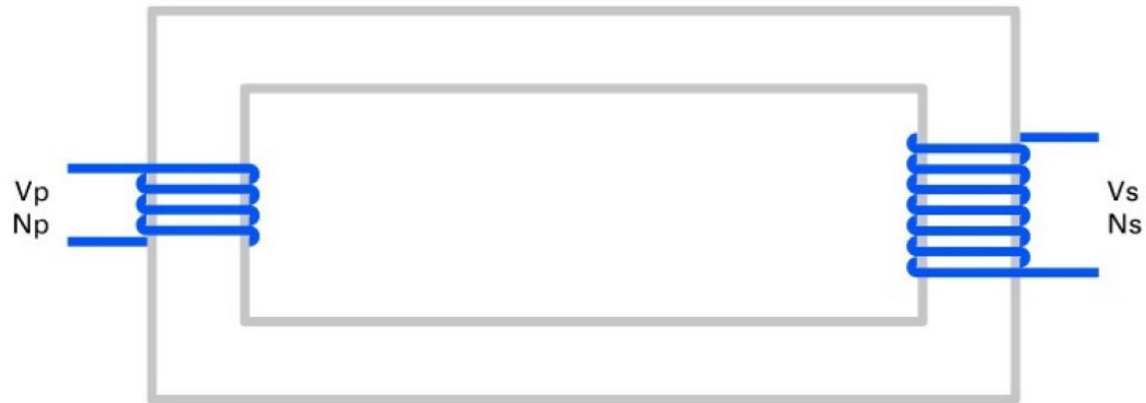
Figura 2.2: Transformador de potencia elevador
