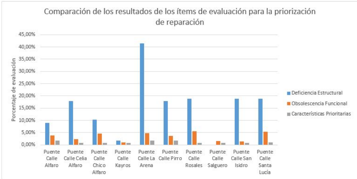
Figura 75. Comparación de los resultados de los ítems de evaluación para la priorización de reparación.
