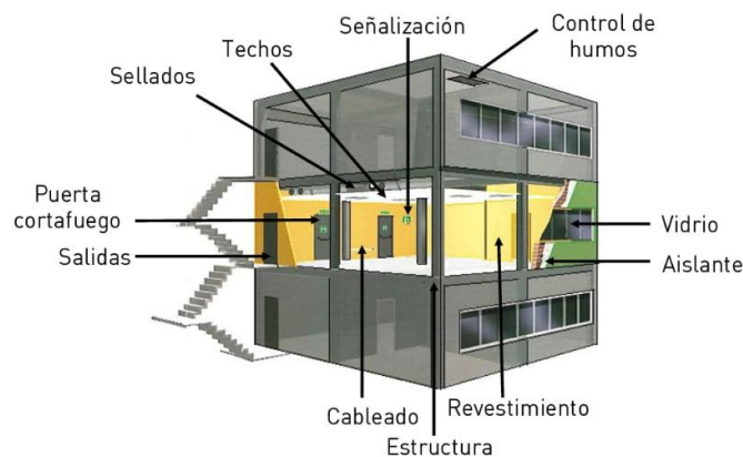
Figura 13. Estructura con protección pasiva. Gutiérrez & Romero (2021)
