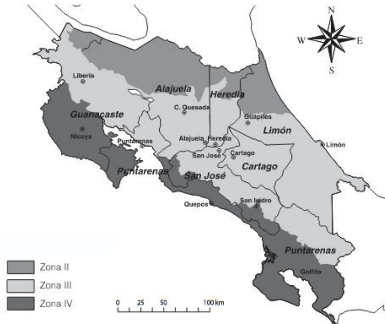
Figura 55. Zonificación Sísmica. Código Sísmico de Costa Rica (2010)
