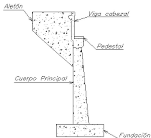
Figura 2. Elementos de un Bastión. Fuente: MOPT (2007).
