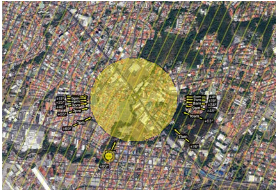
Comportamiento solar para el equinoccio de primavera 2024 a las 12 horas. Fuente: Sun Seeker. Adaptación propia
